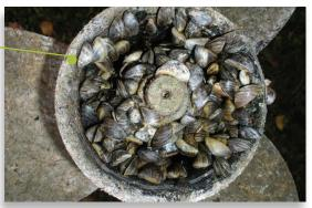
Moules zébrées fixées sur une hélice de bateau
